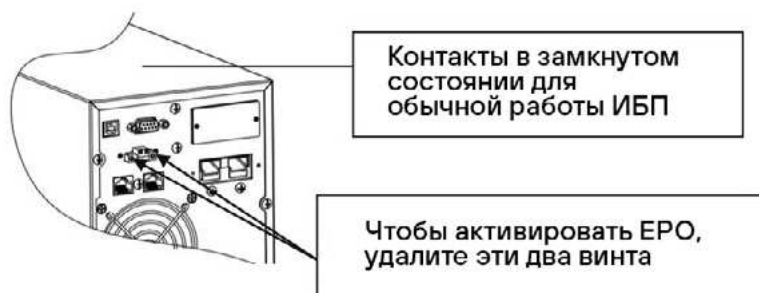
Рисунок 3. Разъем аварийного отключения EPO
